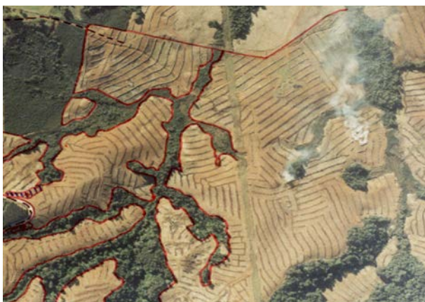
Figura 12.4. Fotografía aérea ilustrando cómo se puede controlar la erosión mediante la preservación de franjas de vegetación natural en la orilla de los cursos de agua y disposición de los desechos de corte siguiendo las curvas de nivel.
