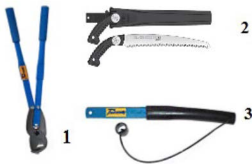
Figura 8.15. Herramientas más utilizadas en poda en Chile. (1) Tijerón neozelandés ( Prune-Off Lopper ). (2) Serrucho cola de zorro. (3) Sierra para epicormios.
