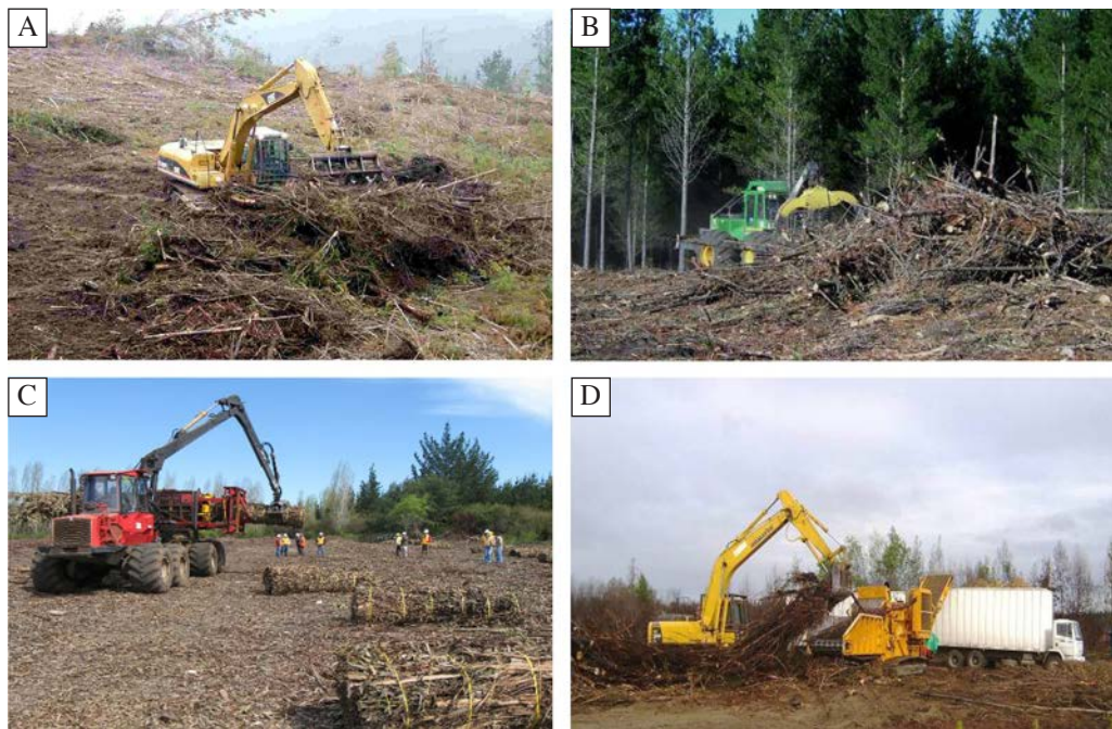
Figura 9.1. (A) Acopio de residuos de cosecha por excavadora. (B) Transporte primario de residuos a través de skidder grapple . (C) Enfardado de residuos de eucaliptos. (D) Astillado de residuos con triturador CBI Magnus Force 8400.
