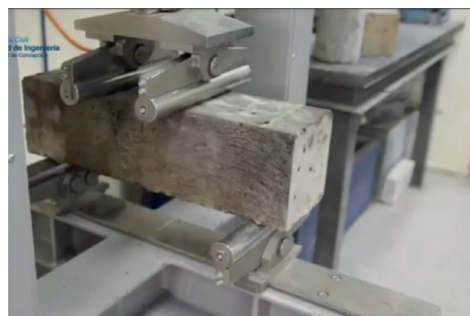
Figura 10: Ensayo de compresión (izquierda). Ensayo de flexotracción (derecha)
