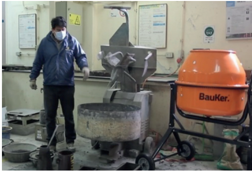
Figura 9: Confección de hormigón (izquierda). Llenado de probetas (derecha)
