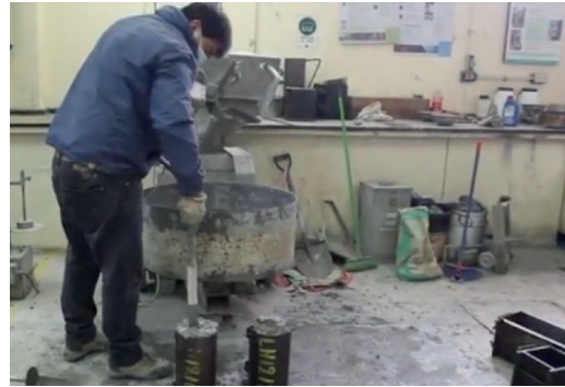
Figura 9: Confección de hormigón (izquierda). Llenado de probetas (derecha)
