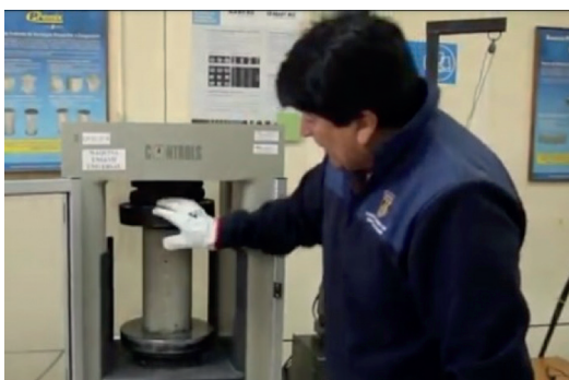
Figura 10: Ensayo de compresión (izquierda). Ensayo de flexotracción (derecha)
